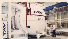
I forni TAV VACUUM FURNACES trovano utilizzazione nei trattamenti termici di acciai e leghe, nelle operazioni di tempra, rinvenimento, solubilizzazione, ricottura, brasatura e sinterizzazione.
