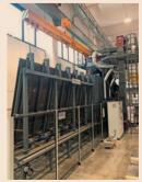
lamiera verticale per la fase di carico e orizzontale per quella di scarico. L'ottimo risultato finale su entrambe le viste della lamiera è garantito dalle 8 turbine con potenza di 11kw l'una, mentre il sistema automatico di ricircolo e separazione dell'abrasivo consente l'immissione in macchina di graniglia sempre pulita.
